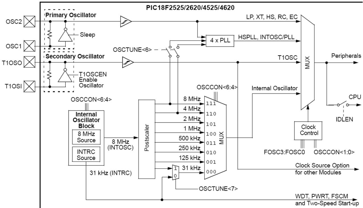
Configuration de l'horloge interne, on suppose que les bits de configuration active la base de temps de 8MHz :
