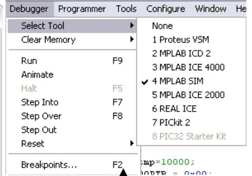
Sélectionner le type de debugger (en général ICD2 ou ICD3)
