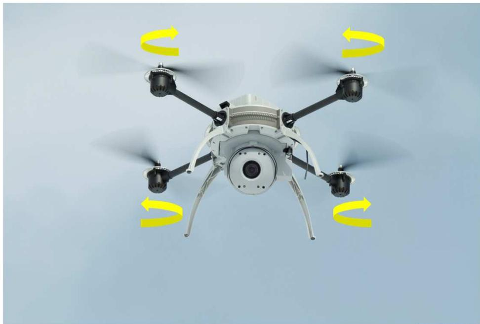
La stabilité du vol est assurée par l'inversion en alternance de la rotation des hélices
