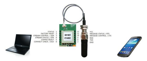
Etablir une communication par Bluetooth entre un ordinateur et un terminal Android à l'aide d'un module FIRMTECH FB755AS
