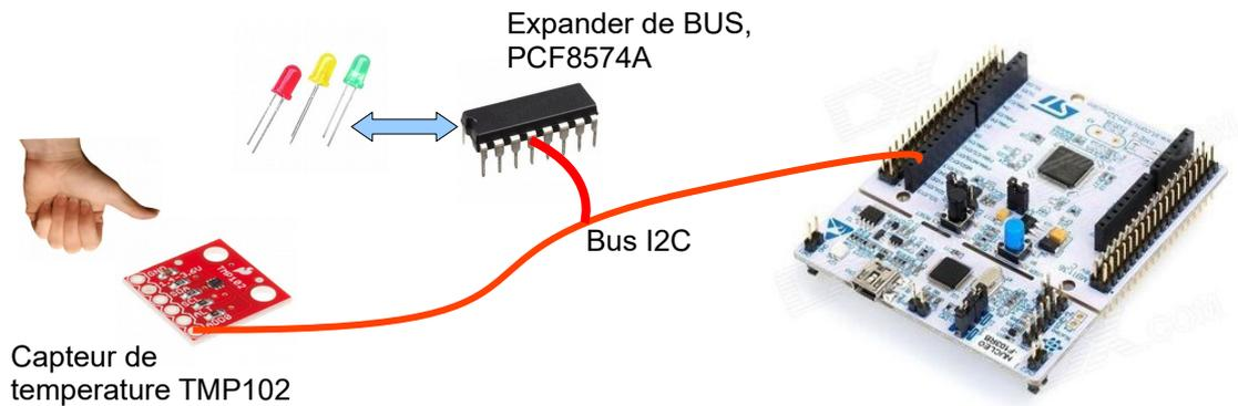
Le capteur de température TMP102 et l'expander PCF8574A communiquent sur bus I2C
