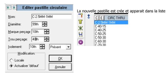
Pour créer un trou de fixation,réaliser une pastille avec le trou voulu et une epaisseur de cuivre de 1th (le minimum possible)
