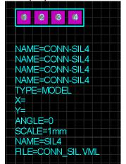
Placer les nouvelles pastilles, modifier éventuellement les anciennes (le modèle STDDIL permet de placer une piste de 0,5mm entre deux pastilles) Numéroter les partilles Aggrandir la sérigraphie
